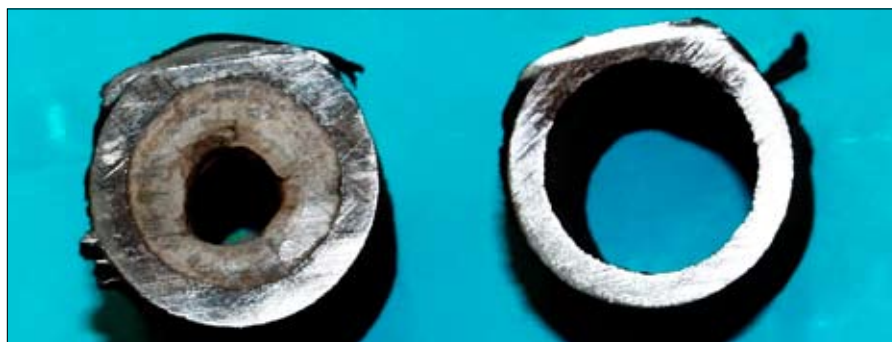
Рис. 1. Слева: состояние трубопровода при эксплуатации без выполнения подготовки питательной воды, справа – при эксплуатации с использованием воды, обработанной реагентом марки «КИСК»
